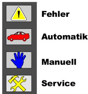
Die Steuerung arbeitet in insgesamt drei Betriebsarten, die über den Betriebsartenwahlschalter am Steuerpult gewählt werden können. Die gewählte Betriebsart wird durch eine eingeschaltete Leuchtdiode in der Betriebsartenanzeige gekennzeichnet.
